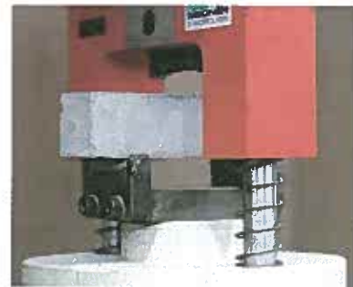
Bild 2: Prüfung der Biegezugfestigkeit
