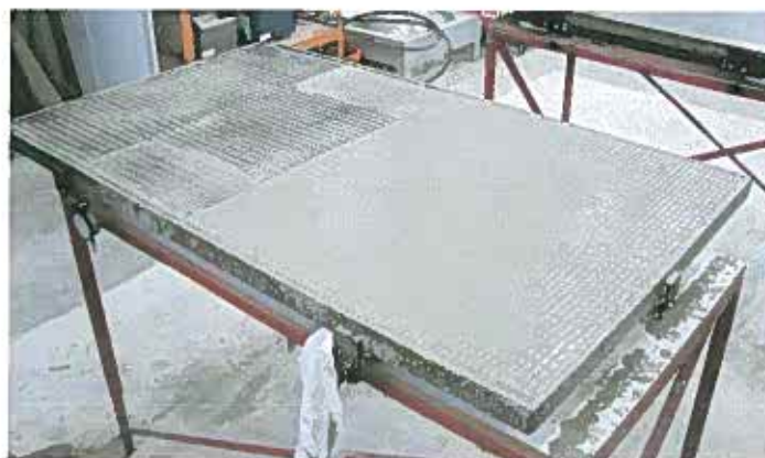
Bild 3: Herstellung der Textilbetonplatte
