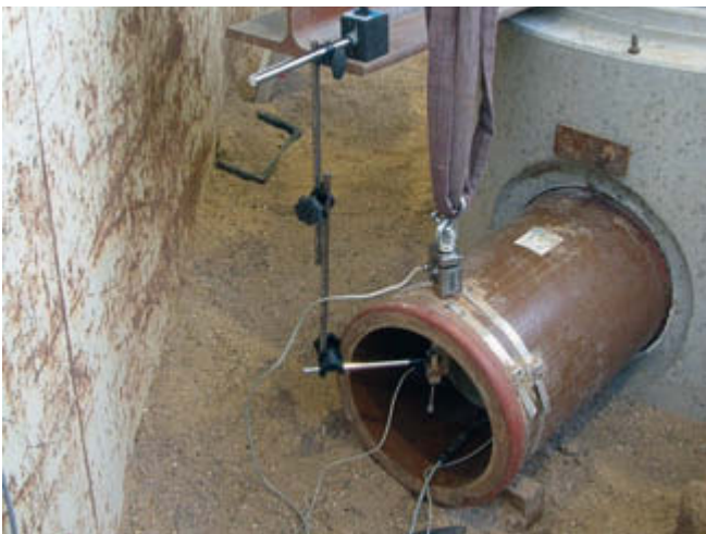
Abb. 4: Betriebsbelastung bei Abdichtungen an Rohranbindungen: sanierte Rohranbindungen zur Dichtheitsprüfung freigelegt (oben, links); Fahrzeug für Hochdruckreinigung (oben, rechts); Versuchsaufbau Abwinkelungsversuch (unten, links); Undichtigkeit einer Acryl-Injektion infolge Hochdruck-Reinigung (unten, rechts)
