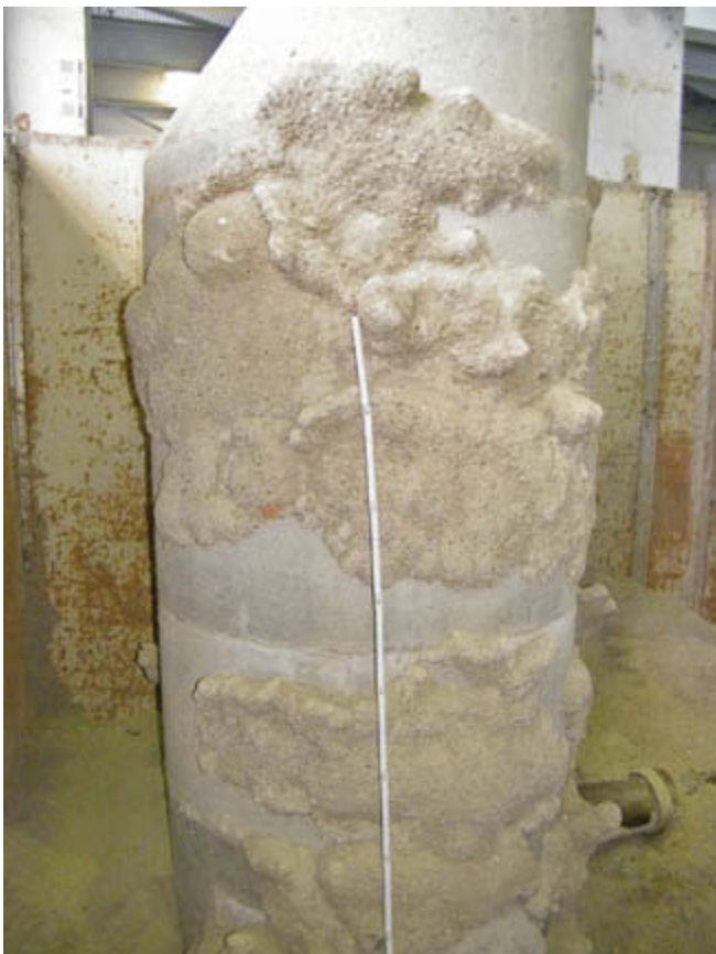
Abb. 2: Freilegung der Versuchskörper im Großversuchsstand: Gesamt-Injektionskörper (links); Injektionskörper an PVC-Rohr DN 150 (oben, rechts) und Steinzeugrohr DN 150 (unten, rechts)
