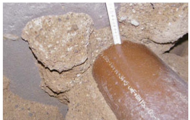
Abb. 2: Freilegung der Versuchskörper im Großversuchsstand: Gesamt-Injektionskörper (links); Injektionskörper an PVC-Rohr DN 150 (oben, rechts) und Steinzeugrohr DN 150 (unten, rechts)
