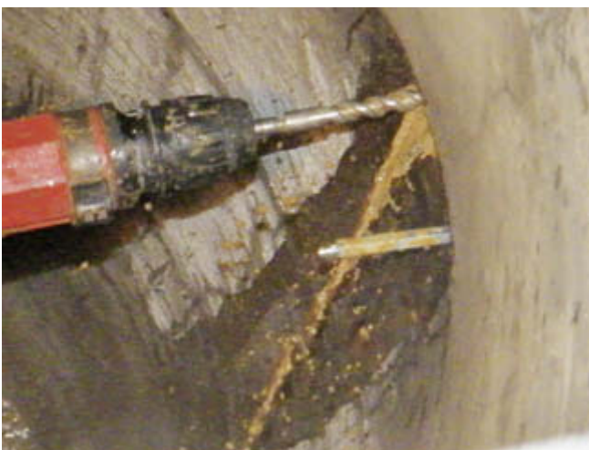
Abb. 3: Applikation im Großversuchsstand: Abdichtung mittels Stopfmörtel, Eindrücken des Reparaturmörtels von Hand in eine Schachtringfuge (oben links) und von Stopfmörtel in eine Schadstelle (oben rechts); Abdichtung mittels Injektion, Bohren eines Packerlochs (unten links) und ausgetretenes Polyurethanharz aus der verdämmten Schachtringfuge (unten rechts)
