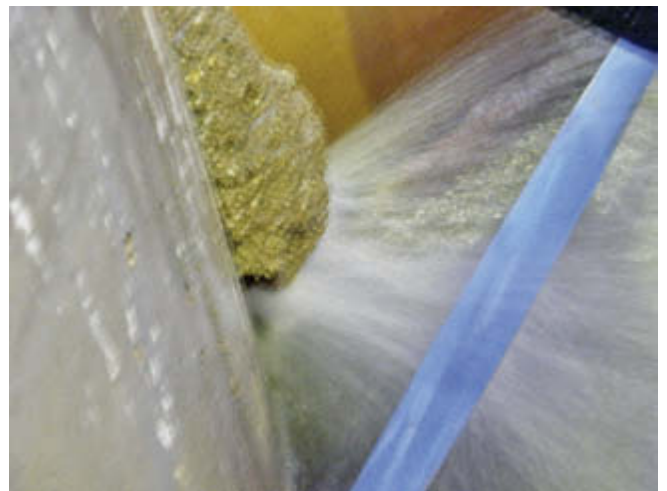
Abb. 4: Betriebsbelastung bei Abdichtungen an Rohranbindungen: sanierte Rohranbindungen zur Dichtheitsprüfung freigelegt (oben, links); Fahrzeug für Hochdruckreinigung (oben, rechts); Versuchsaufbau Abwinkelungsversuch (unten, links); Undichtigkeit einer Acryl-Injektion infolge Hochdruck-Reinigung (unten, rechts)
